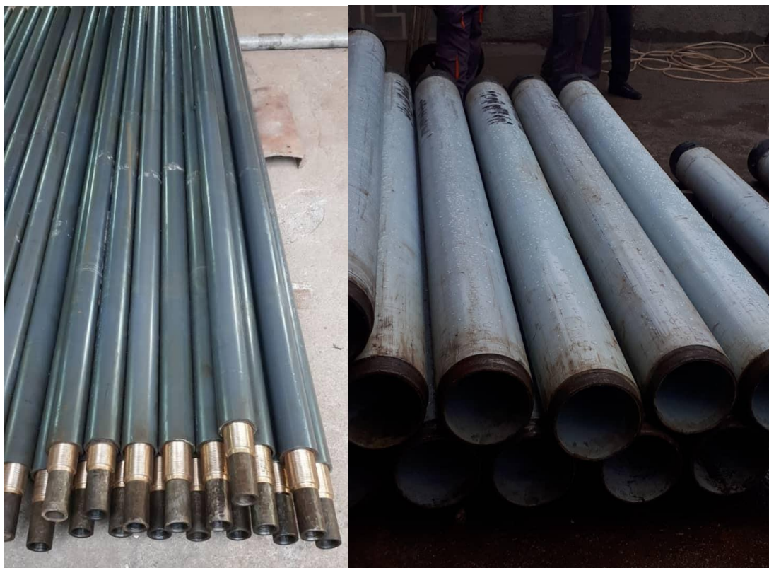
شکل شماره ۳: لوله آبده و غلاف های پوشش دار شده قبل از نصب
