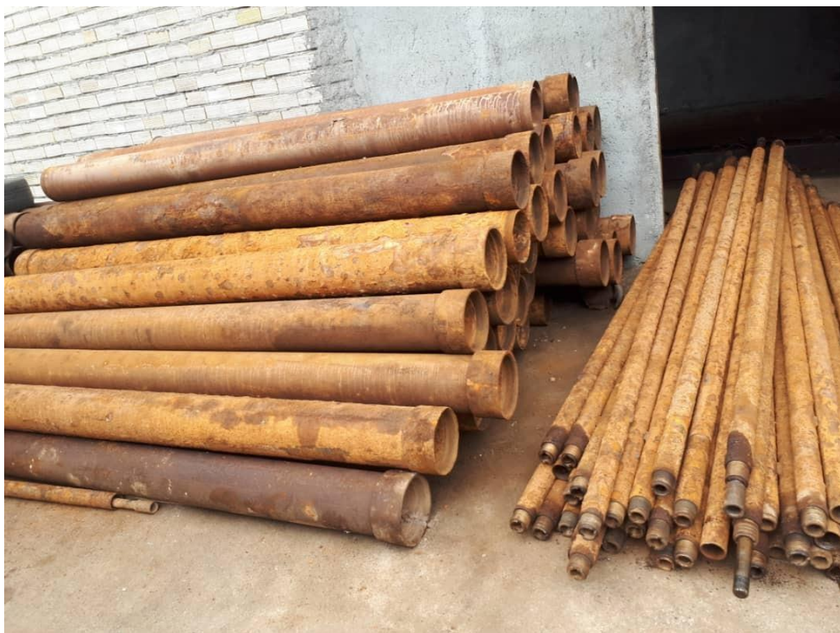
شکل شماره ۱: وضعیت شافت ها و غلاف های زنگ زده داخل چاه
